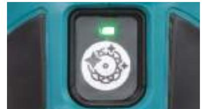
El modo de acabado facilita el pulido fino al mantener el par fijo y controlar la rotación en trabajos pesados.
